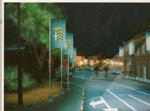
▲ Proposition de mise en lumière pour la porte de Neuville à Soignies. Trois oriflammes implantés de part et d'autre de la rue créent un effet de porte. Elles sont éclairées par une lumière rasante à LED. Les arbres sont mis en lumière par un éclairage en contre plongée. Des projecteurs équipés de grilles de défilement sont fixés sous la corniche pour renforcer l'éclairage de la voirie jusqu'au carrefour. © Light To Light, 2006
